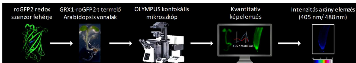
12. ábra Redox potenciál meghatározásának sematikus menete redox szenzitív zöld fluoreszcens fehérje (roGFP2) használatával Schwarzländer és mtsai. (2008) alapján.
