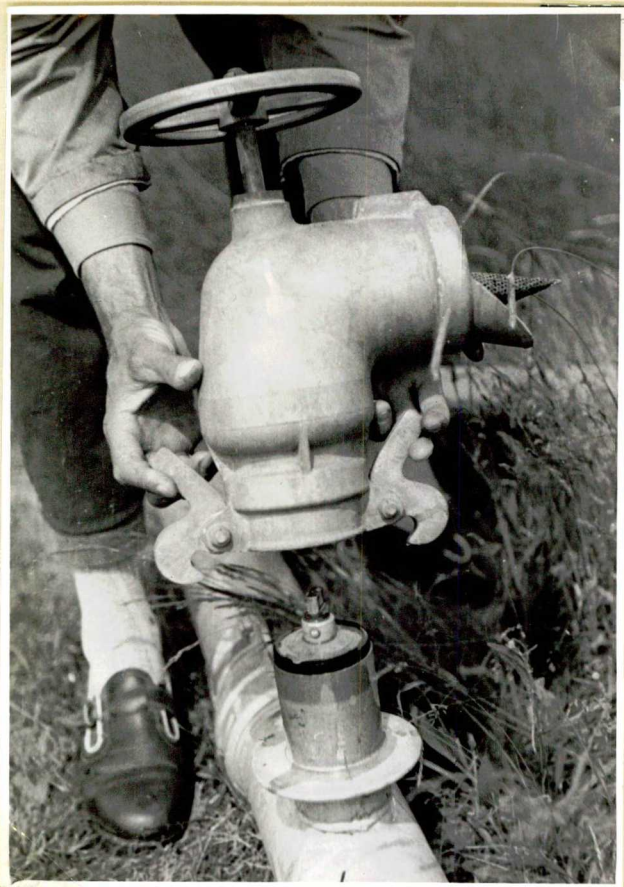
46. kép. Elágazás tölcésérialaku szűrővel.
