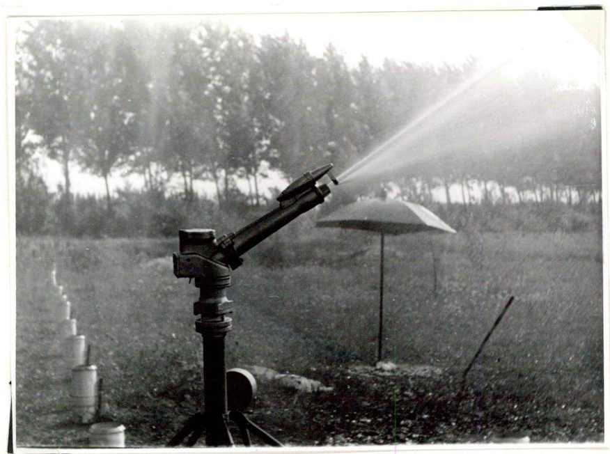
27. kép. Permetező öntözés /ÉVA - szórófej/
