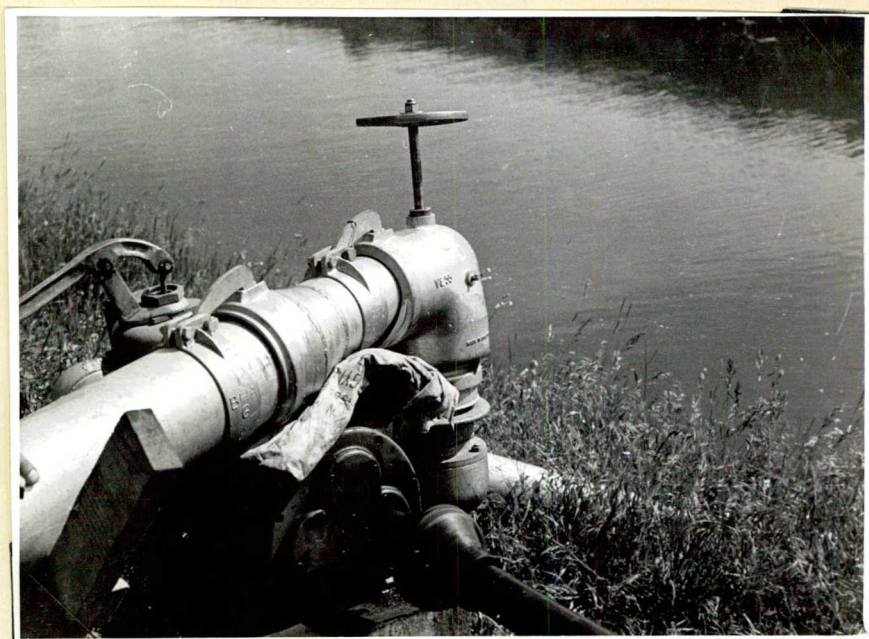
43. kép. Wirght Rain nagyerejű szivattyu
