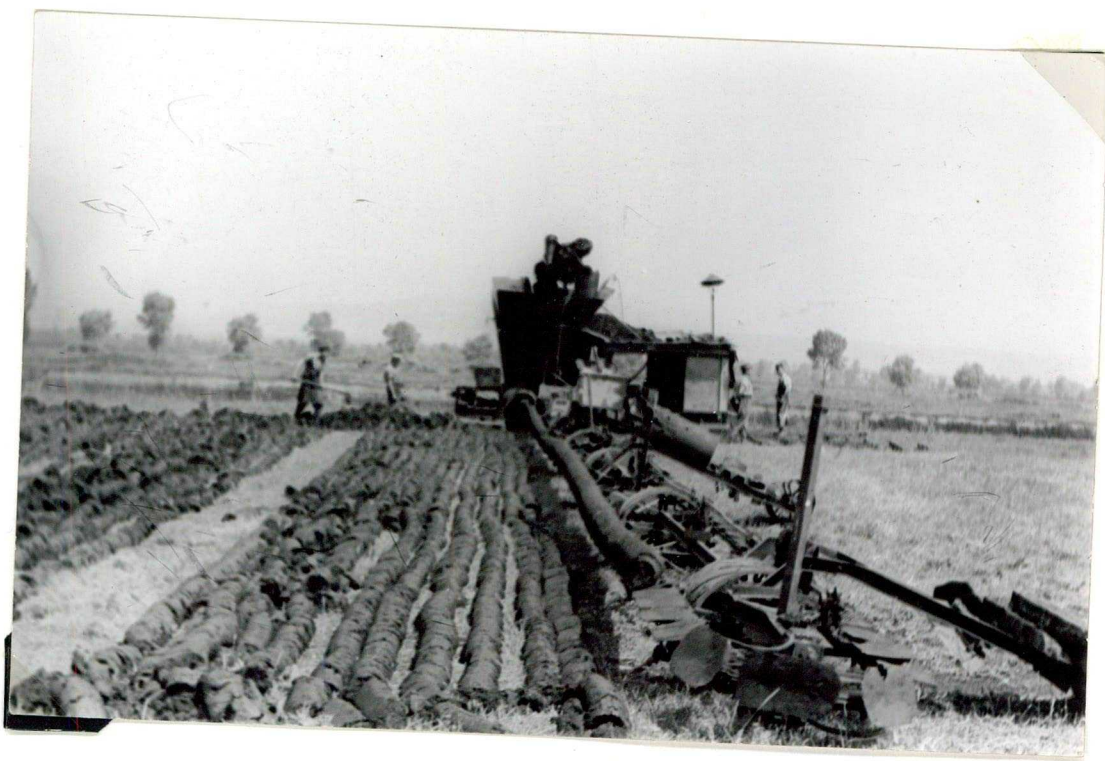
2. kép. Gépi, gyurt tőzegkitermelés
