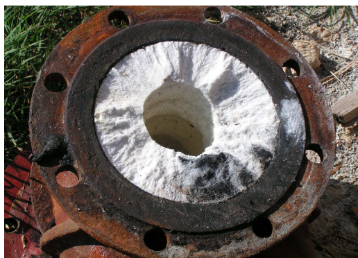
2.1. kép: Vízkőkiválás egy termálkút csövének belső falán (Szentes, 2006)
