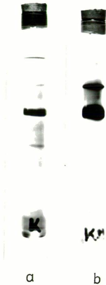
3. ábra: Tisztított alkohol oxidáz tisztaságellenőrzése poliakrilamid gélelektroforézissel. a/ fehérjére- b/ enzimaktivításra festett gél
