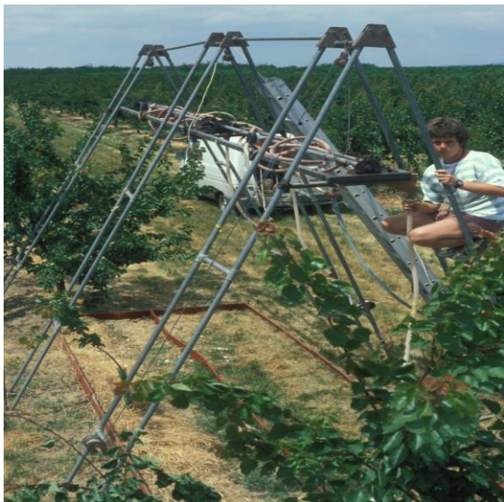
14. kép: A barackosban és a szántón felállított esőztető berendezés
