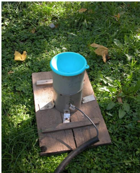
6. kép: A csapadékmérő billencs tölcserrel illetve tölcser nélkül
