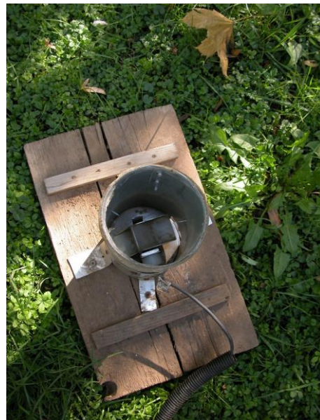
6. kép: A csapadékmérő billencs tölcserrel illetve tölcser nélkül
