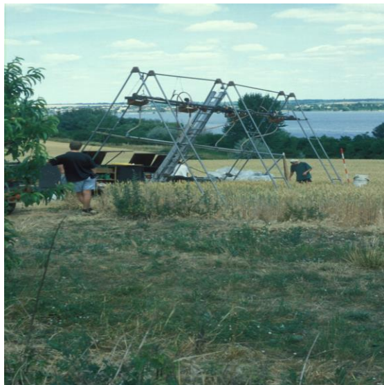
14. kép: A barackosban és a szántón felállított esőztető berendezés
