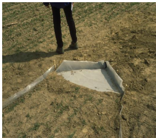
7. kép: A szántón kialakított parcella és az alján található gyűjtőláp
