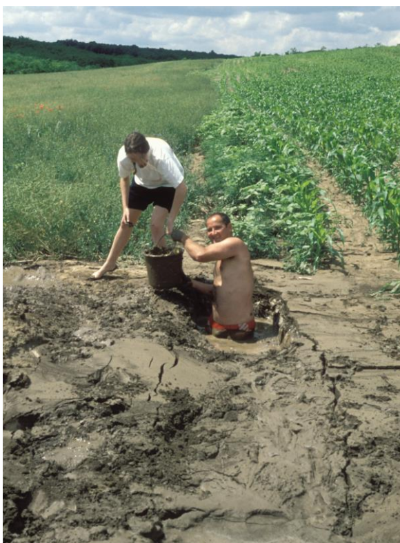
2. kép: A szuszpenzió térfogatának meghatározása és eltávolítása az árokból
