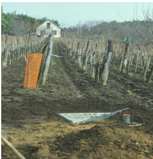
11. kép: A szőlőben kialakított eróziós parcella
