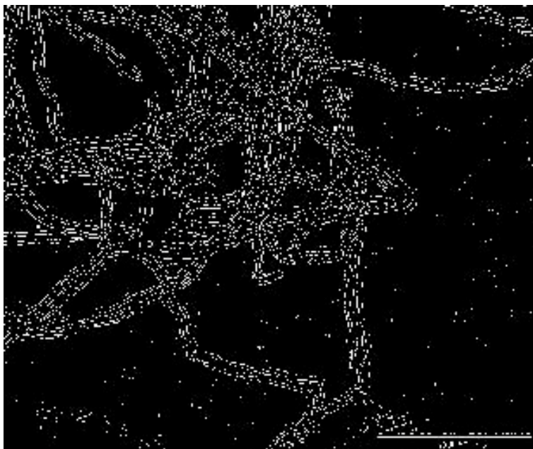
48. ábra. A vizsgált TEM kép Sobel -módszerrel analizált bináris képe
