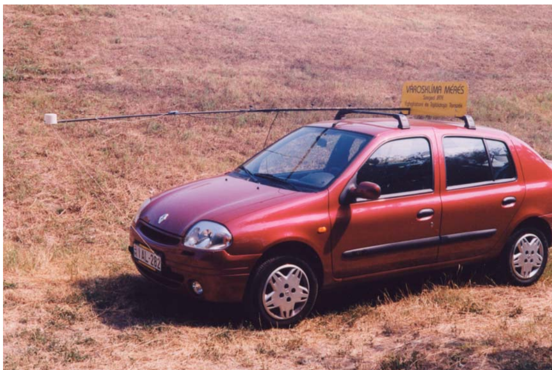
6.2.3. ábra Az egyik mérőautó a rúdra szerelt hőmérsékleti szenzorral
