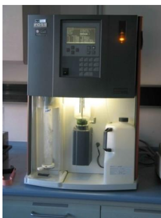
18. ábra : Kjeldahl elven működő roncsoló berendezés (Forrás: saját kép)
