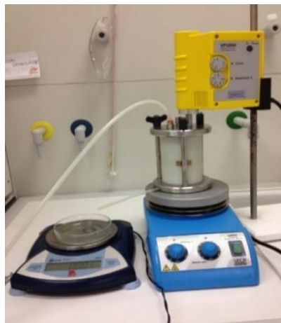
17. ábra: Membránszűrő berendezés ultrahangkészülékkel (Forrás: saját kép)
