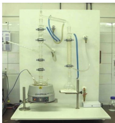
14. ábra: Laboratóriumi desztilláló egység (Forrás: saját készítés)
