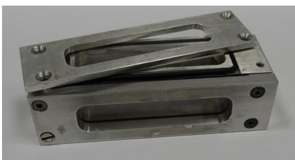
34. ábra: A zárt rendszert igénylő kísérletek számára, a szilárd hordozóban kialakított mélyedéseket tartalmazó lemezt befogadni képes mintakamra.
