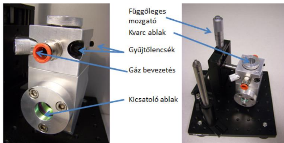
23. ábra: A tömbi szénminták és az aeroszol részecskék LIBS vizsgálatára kialakított mintakamra.
