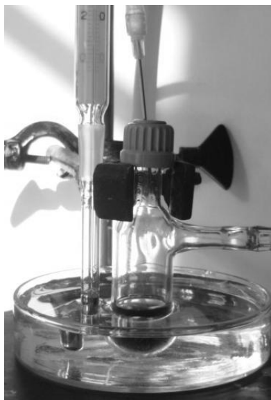
3.7. ábra: A katalitikus transzferhidrogénezés kivitelezéséhez használt berendezés
