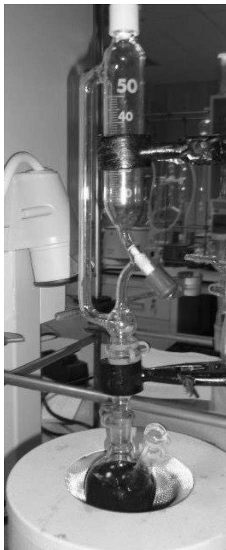
3.3. ábra: Az Augustine-módszerrel történő heterogenizálás kísérleti összeállítása
