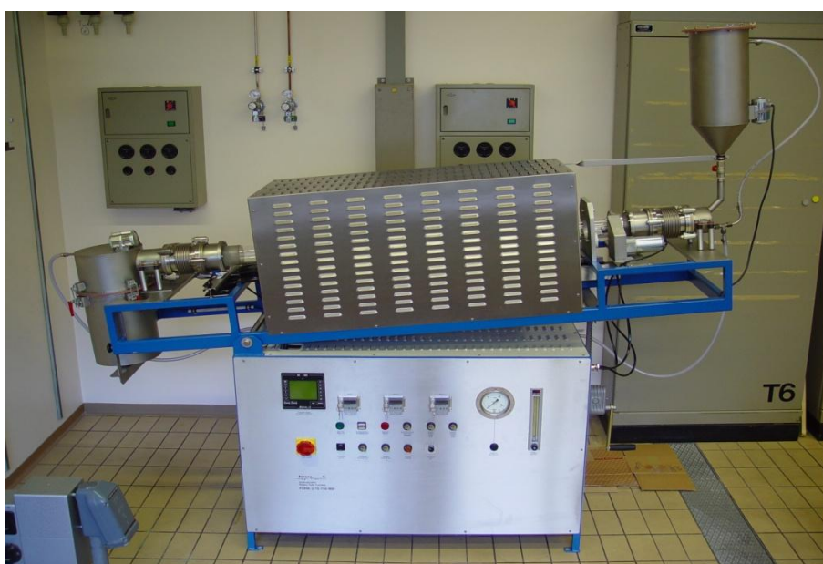
2. ábra: Többfalú szén nanocsövek előállítására szolgáló forgó csökemence (EPFL-Lausanne) [36]
