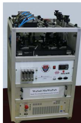
4.22. ábra: A fotoakusztikus aeroszolmérő rendszer laboratóriumi (bal oldali kép) és terepi (jobb oldali kép) változata.
