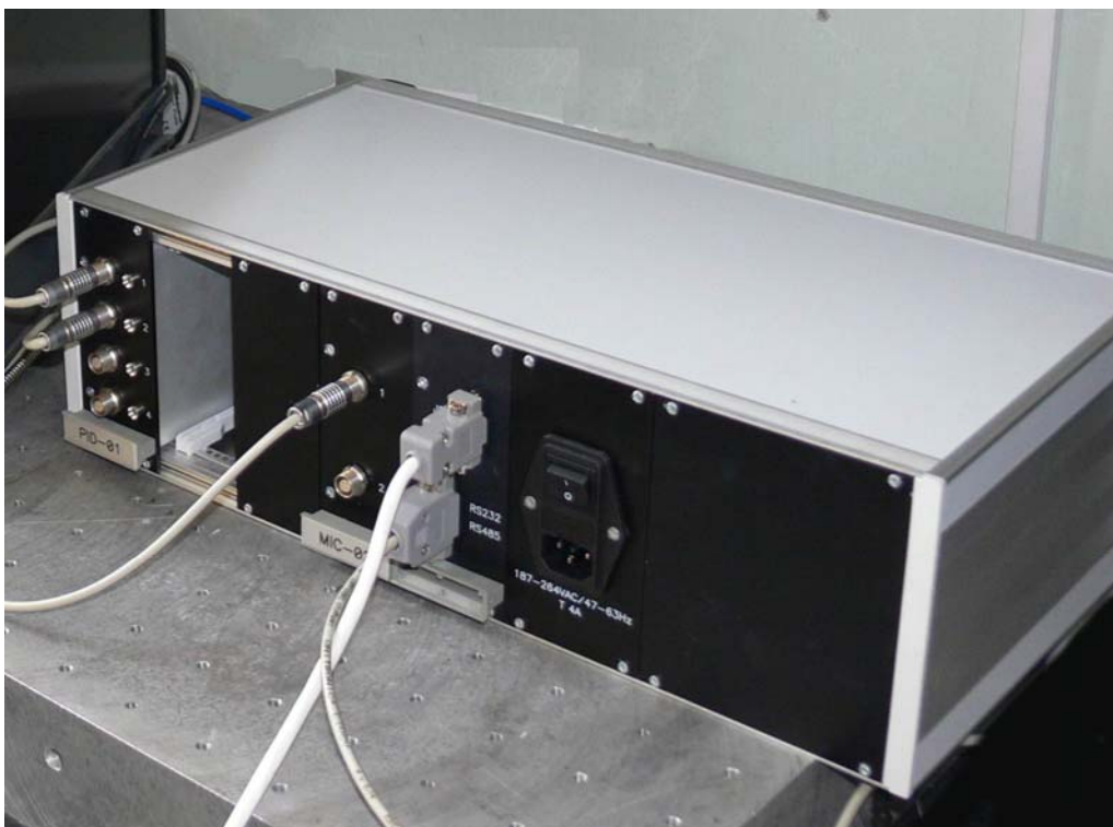
4.8. ábra: A fotoakusztikus aeroszolvérő rendszerben alkalmazott mérésvezérlő elektronika.
