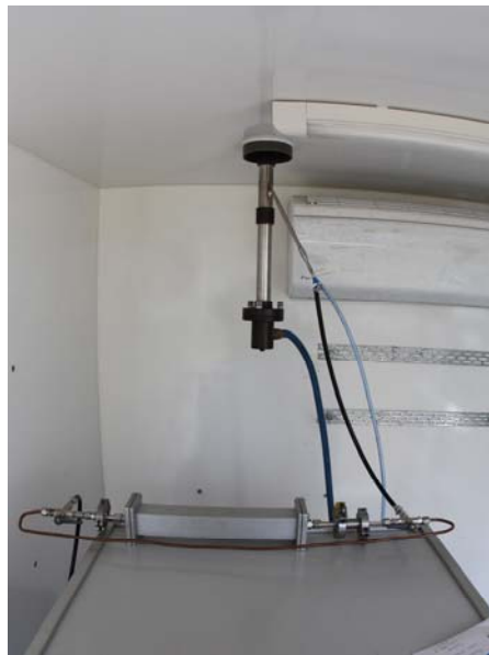
4.25. ábra: A kis térfogatú gravimetriás tömegmérő és a fotoakusztikus aeroszolvérő műszer azonos leválasztó-fejen keresztüli izokinetikus mintavételezést biztosító elosztócsoknya.
