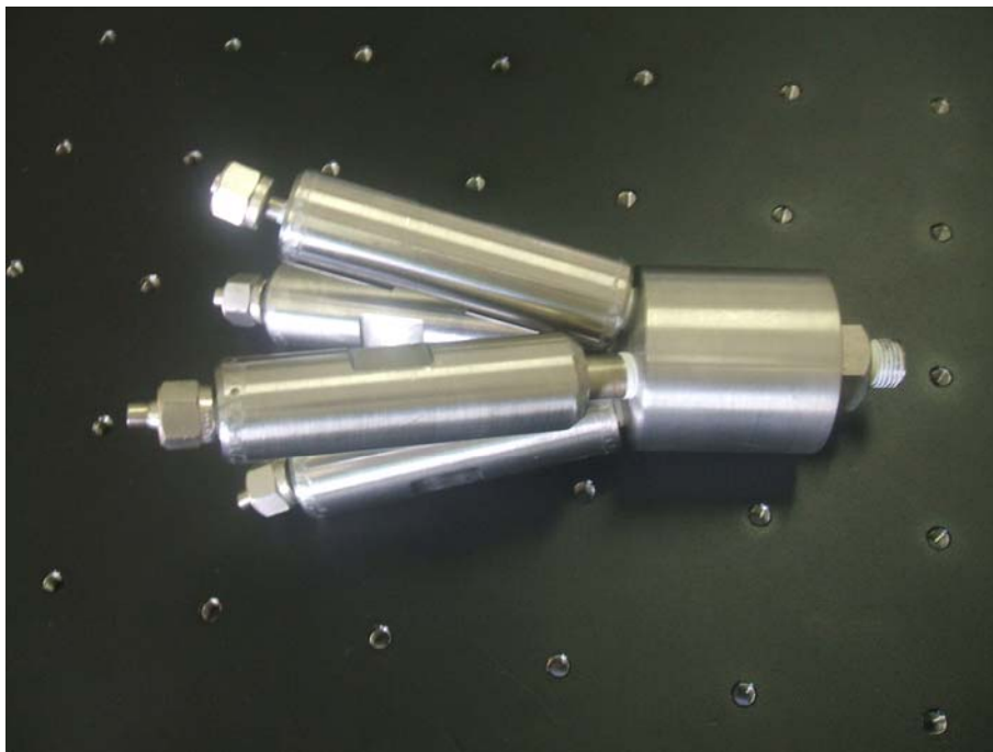
4.7. ábra: A fotoakusztikus rendszerben alkalmazott speciális elosztócsonk.
