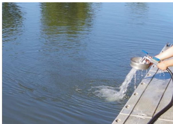
8. ábra: Vízmintavétel szivattyúval.
