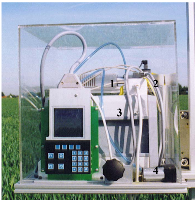
40. ábra: A terepi mérésekhez előkészített fotoakusztikus ammóniamérő rendszer
