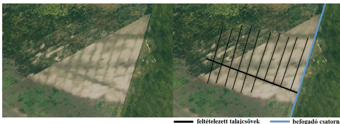
30. ábra. Légifelvételen megjelenő távolságméréssel validált (15 m) dréncső nyomvonalak Kunszentmárton közelében. A nyílt talajfelszínen megjelenő dréncső nyomvonalak folytatása megfigyelhető a növényzettel borított területen is. (TÚRI ÉS TÁRSAI 2018)
