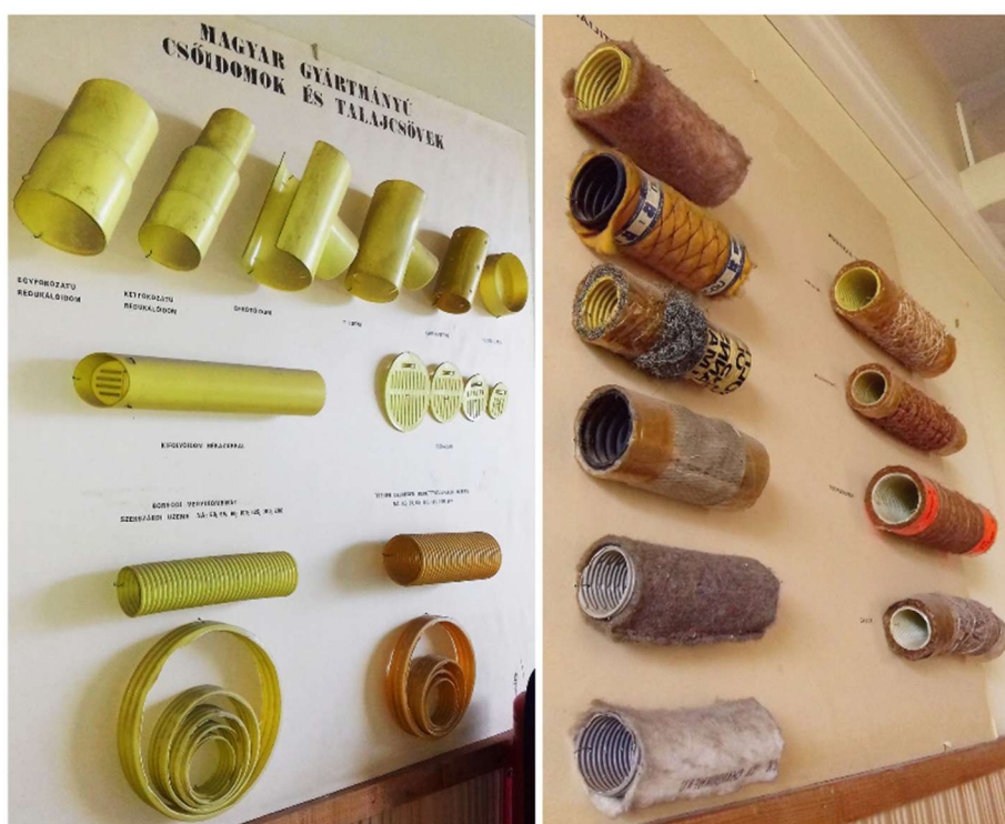
6. ábra. Dréncső típusok és jellemző szűrőzési anyagai prezentációs tablói a nagyüzemi meliorációs oktatás fénykorából a MATE Öntözésfejlesztési és Meliorációs Tanszékén (Fotók: Túri N.)
