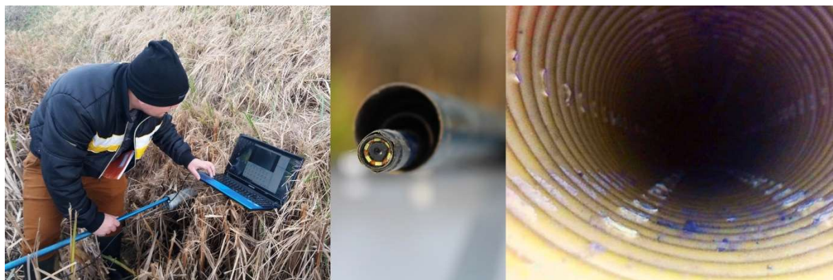
50. ábra. A drének bevezető szakaszainak endoszkópos vizsgálata (TÚRI ÉS TÁRSAI 2021)
