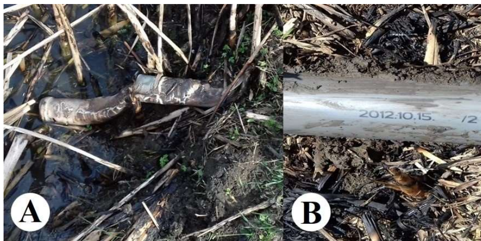
49. ábra. A drének jellemző sérülései: (A) megolvadt PVC drénkifolyó a befogadó csatorna rézsűjében, (B) 10 éve gyártott dréncső kifolyó, amely néhány év alatt elmozdult a telepítési helyéről (TÚRI ÉS TÁRSAI 2021)
