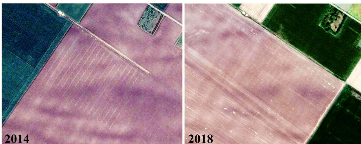
4. melléklet. Az ároknyitással fektetett drének nyomai a telepítésük után több évvel is interpretálhatók a Google Earth műholdfelvételeken
