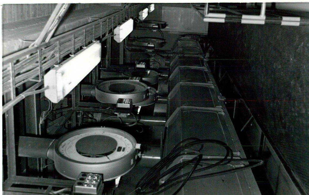
4. kép. A Keverő Üzemben automata mérleg sor biztosítja az alapanyagok megfelelő összetételét
