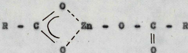
3.4.2. ábra: A \text{Zn}(\text{eh})_2 szerkezete, kötésviszonyai első közelítésben
