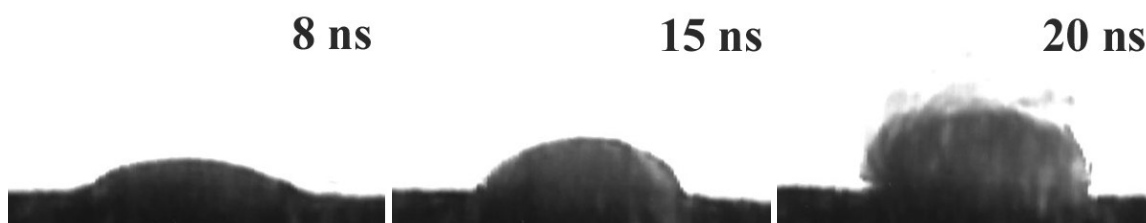
3.6. ábra Impulzslézeres besugárzást követően olvadt bizmut felületéről, ns-os késleltetésekkel készített felvételek. A képek szélessége 0,55 mm-nek felel meg.
