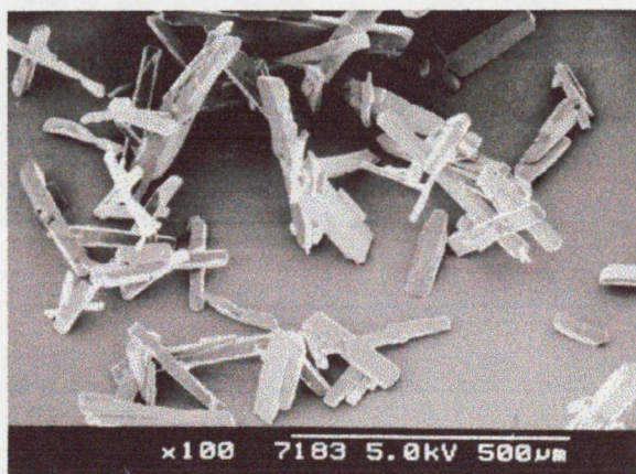
Fig. 3. Crystals of control ASA.
