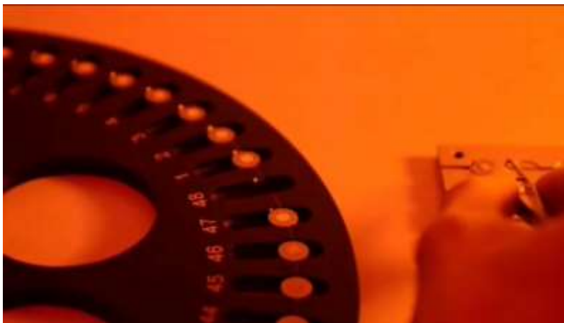
21. ábra: Acél korongokra ragasztott kvarc szemcsék (fotó: Dr. Sipos György)
