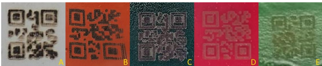
4. ábra. Félvezető lézerrel kezelt Sepifilm bevonófilmek fényképei. A: SPW-W, B: SPW-R, C: SPW-G, D: SNC-P, E: SNC-G.
