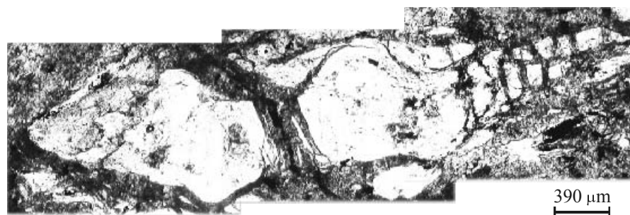
5.1.6. ábra Kvarc boudinage, amely a duktilis deformációt követően csokoládétábla-szerűen összetöredezett (összetett mikrofotó).
