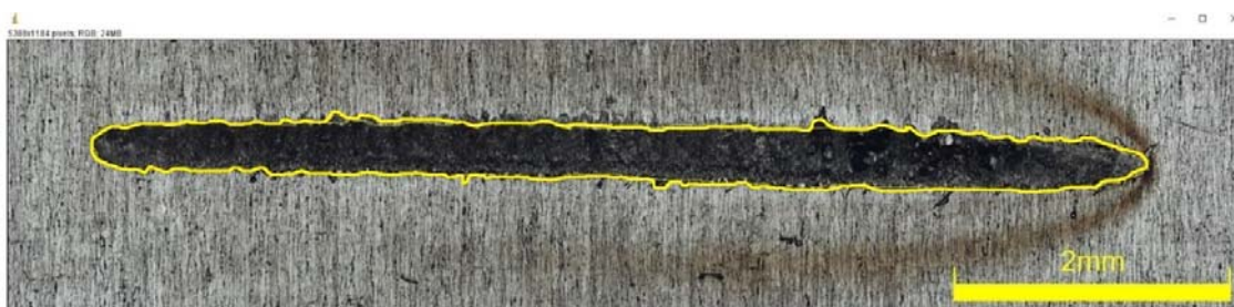
14. ábra: A kötési keresztmetszet meghatározása ImageJ program segítségével a minta elszakítása után. A sárga vonal jelöli a határt.
