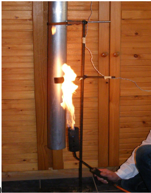
5.7. ábra Ha a gázégő teljesítménye túl nagy volt, akkor szétolvadtak a rácsok: (a) disznópörzsölő; (b) szétolvadt acélrács.
