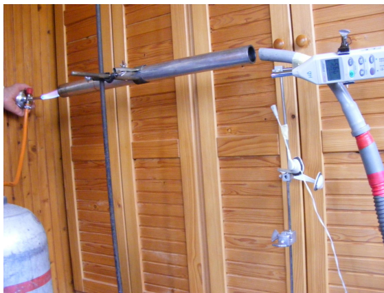
5.8. ábra Vízszintes helyzetű Rijke csőben is keletkezhet hang, ha megfelelő nagyságú légáram intenzitást biztosítunk pl. egy porszívó segítségével.
