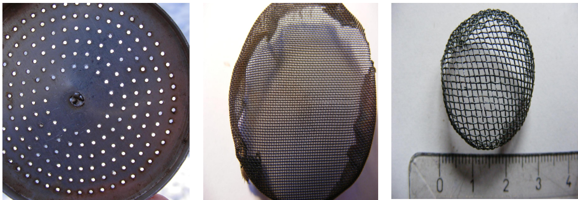
5.2. ábra Különböző akadályok. A drótrácsok áteresztőképességének meghatározása digitális fénykép alapján történt.
