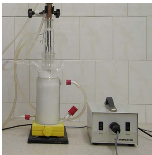
9. ábra (a) Merülőlámpás fotoreaktor és (b) pyrex betétben lévő fényforrásának spektruma
