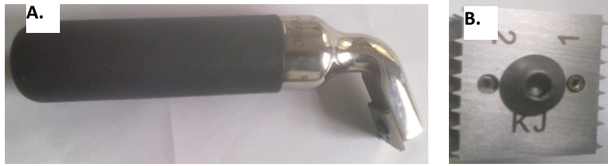
9. ábra Elcometer 107 típusú rácsvágó készülék (A.), valamint a készüléken található fogak (B.) fotója
