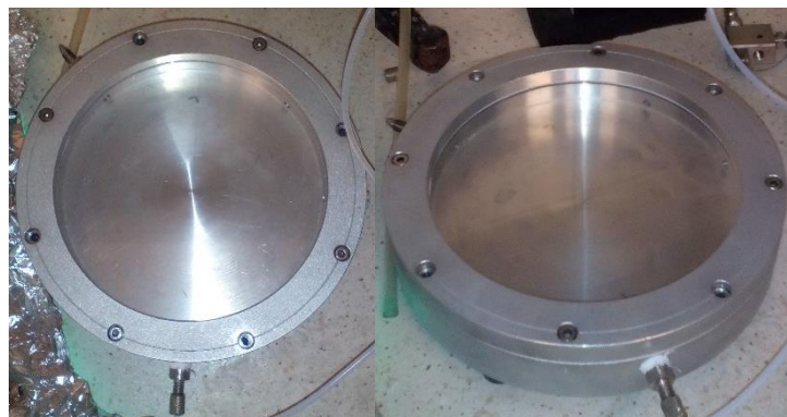
14. ábra A filmek fotokatalitikus vizsgálatára használt FV-165 reaktor
