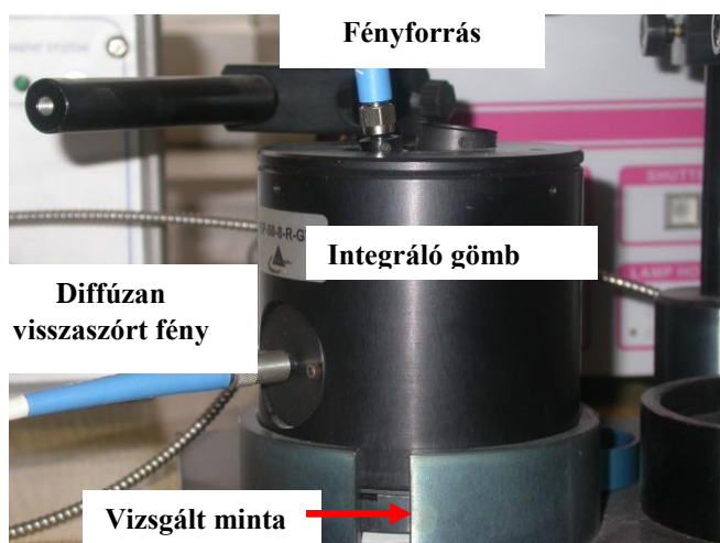
12. ábra A diffúz- reflexiós mérések során használt kísérleti elrendezés
